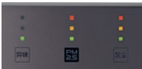
Der Triple Clean Monitor zeigt den Status von Geruch, PM2,5 und Staub an.
